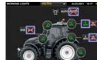
Es fácil configurar las luces de trabajo con la pantalla táctil de 9". Las luces de trabajo Premium y Premium+ también incluyen luces de esquina automáticas, que se controlan mediante un sensor de ángulo de rueda en el eje delantero.
