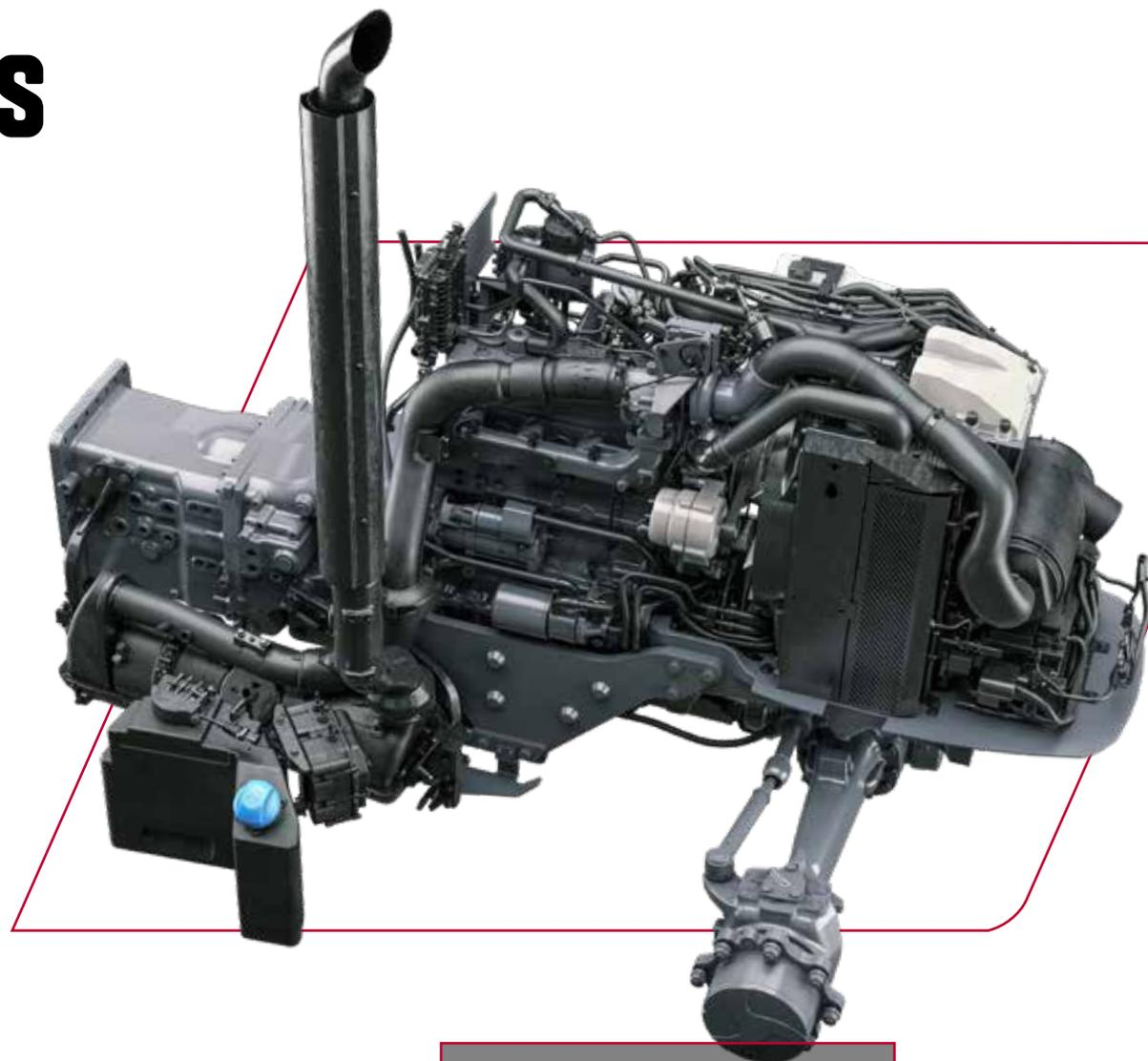
gases de escape de fase V está situada bajo la cabina para ofrecer una visibilidad óptima. El paquete completo incluye DOC, DPF y SCR con AdBlue y, como no hay recirculación de gases de escape (EGR), el motor siempre utiliza aire fresco y limpio.
