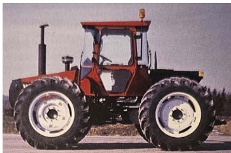
Presentado en 1987, el H800 con dirección en el bastidor se adelantó a su tiempo gracias a su versatilidad y a su consola de dirección giratoria. Su principal inconveniente era la transmisión hidrostática, que estaba aún inmadura.
